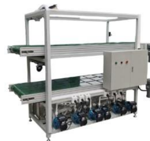
电水壶静止输送线
